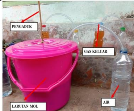
Gambar 2. Rangkaian alat pembuatan MOL Bonggol Pisang (BOPI)
