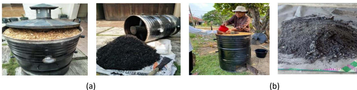
Gambar 1. Visualisasi demonstrasi dan pendampingan memproduksi biochar dengan alat drum pirolisator oleh Kelompok Tani Jaya Bersama dari bahan baku serbuk gergaji (a) dan sekam padi (b).
